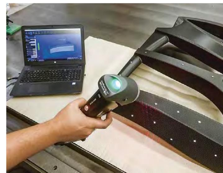
*Vermessung von 3D-Geometrien mit modernster Scantechnologie.*
