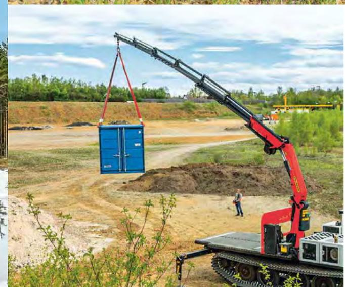
*Mit einer Nutzlast von 16,6 Tonnen ist der PowerBully 18T die perfekte mobile Basis für zahlreiche Aufbauten.*
