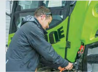
6,5 Stunden braucht die Batterie aktuell zum vollständigen Laden – um dann 2,5 bis 3 Stunden zu arbeiten.
