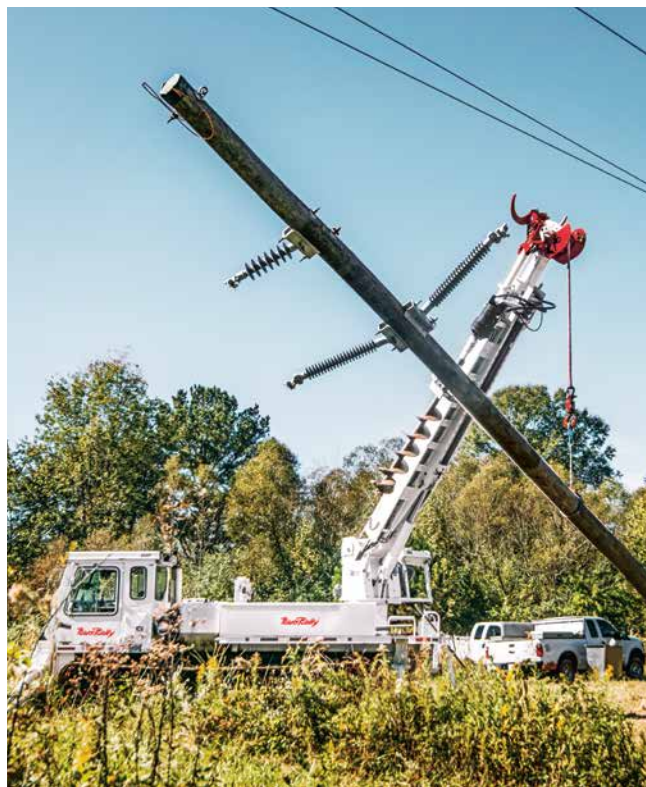
Il PowerBully 18T è utilizzato, tra l'altro, dalle aziende fornitrici di energia per la costruzione e la manutenzione delle linee di alimentazione elettrica.
