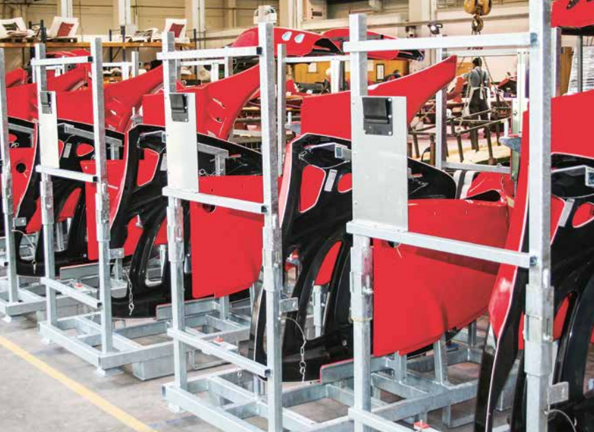
I supporti per gli elementi del telaio portante del PistenBully 600 sono in attesa di essere adeguatamente caricati.
