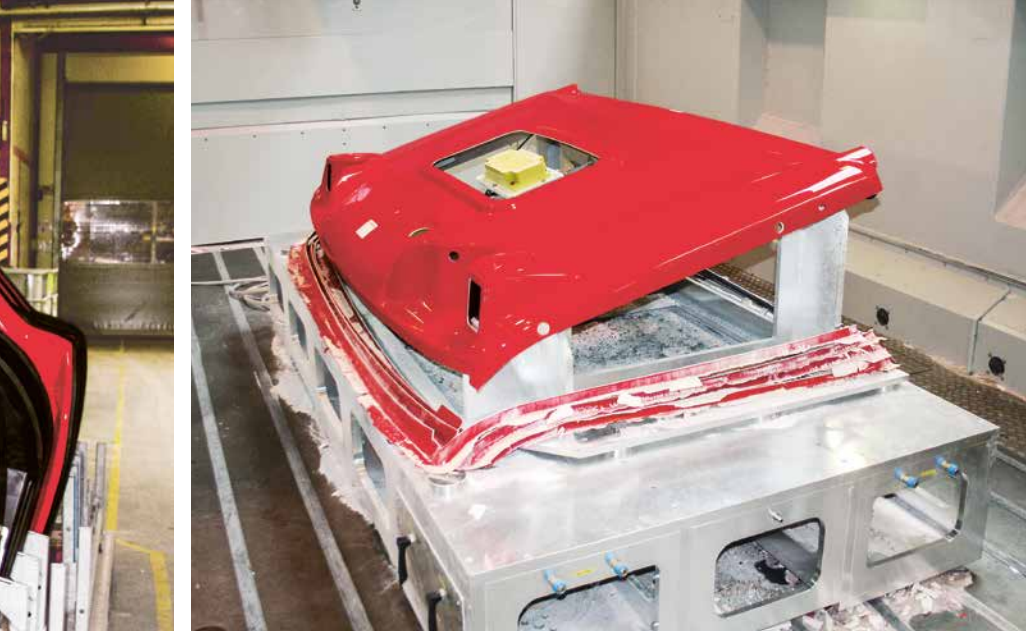
Il tetto del PistenBully 600 dopo la lavorazione nel nuovo dispositivo di fresatura.
