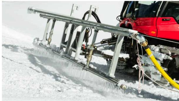
*Cette rampe d'injection a été spécialement mise au point et réalisée par l'équipe de la Coupe du monde.*
