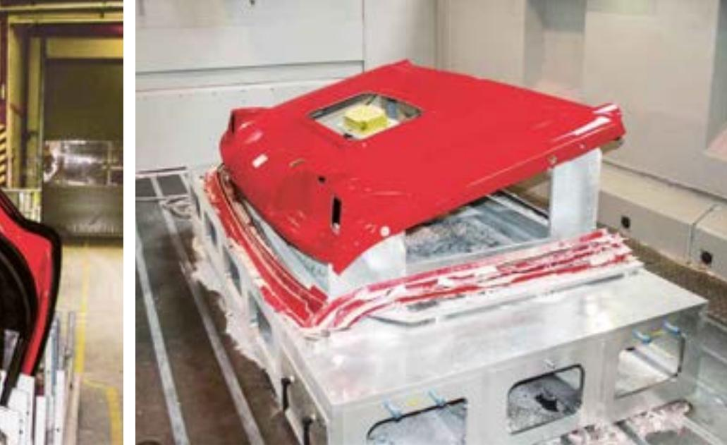
*Dach des PistenBully 600 nach der Bearbeitung in der neuen Fräsvorrichtung.*
