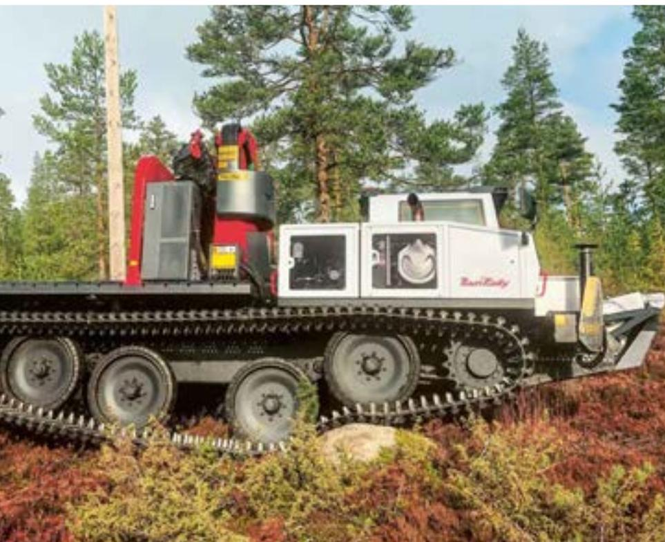
Der PowerBully 18T hat eine Nutzlast von mehr als 16 Tonnen. Ausgestattet mit einem PK 23002 SH mit Greifer und Korb wird er bei einem skandinavischen Unternehmen eingesetzt. Mit den groß dimensionierten Laufrädern passt sich der PowerBully 18T perfekt an den Untergrund an und eignet sich dadurch optimal für den Offroad-Einsatz.
