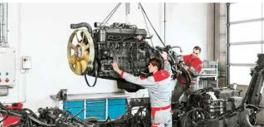
*Wenn die Männer in der Rep mit ihm fertig sind, ist der PistenBully 600 wie neu: komplett überarbeitet, mit Neuteilen und generalüberholtem Motor.*
