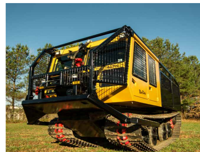
PowerBully 5T FireFighter con aratro antincendio
