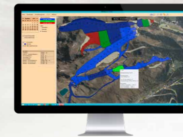
Modulo di gestione della neve di SNOWsat Z: la quantità attuale di neve è visualizzata in colori diversi in rapporto al volume desiderato.
