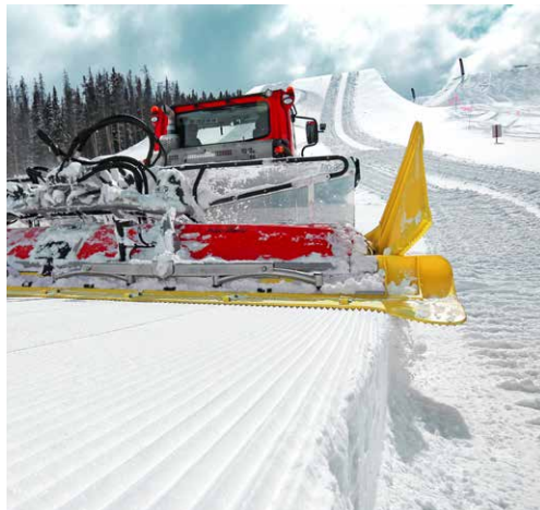
I finisher laterali ribaltabili singolarmente assicurano un lavoro efficace nella fresa ParkFlex
