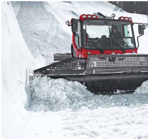
Taglio preciso: l'angolo di taglio laterale perpendicolare della SwitchBlade 2 riduce il lavoro manuale
