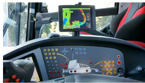
Preparazione delle piste ottimizzata mediante visualizzazione delle tracce del veicolo e della profondità della neve sul touch-screen nel veicolo
