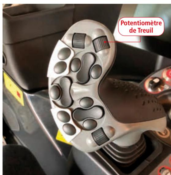
Rappelons qu'en mode automatique, il est toujours possible de « reprendre » le tonnage en manuel à l'aide du potentiomètre de treuil, le treuil reviendra en mode automatique 10 secondes après avoir modifié manuellement le tonnage.
