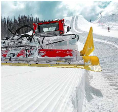
Exakter Schnitt: Die rechtwinklige seitliche Schneidekante des SwitchBlade<sup>2</sup> reduziert die Handarbeit
