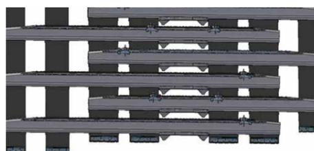
Neue Anordnung, neue Form: die Bestückungselemente der Kombikette Plus für bessere Steigfähigkeit und Schubkraft
