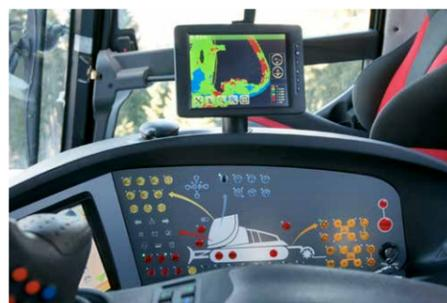
Optimierte Pistenpräparierung durch Anzeige der Fahrspuren und Schneetiefe auf dem Touchscreen im Fahrzeug.
