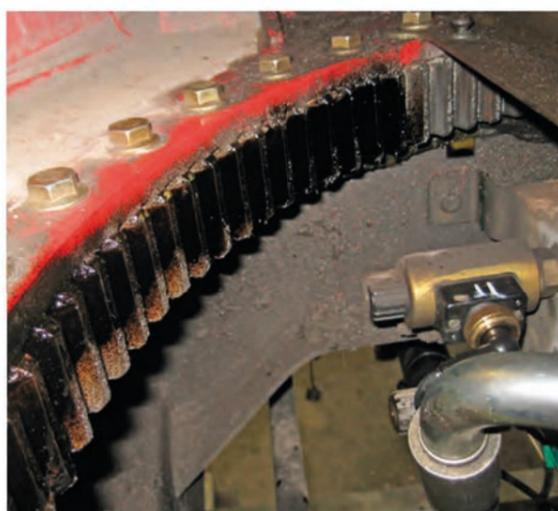
résistance exceptionnelle qui aide à supporter les lourdes charges et permet un espacement des graissages. Il empêche également le contact métal/métal qui peut conduire à une forte usure destructrice. YORK 1219 a été conçu pour être polyvalent et permet aussi de lubrifier tous les engrenages ouverts que l'on peut trouver dans une station de ski et notamment les couronnes dentées des remontées mécaniques.
