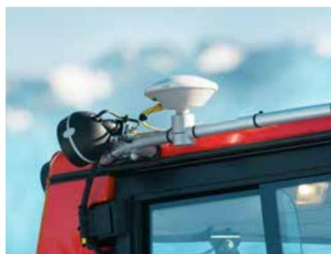
GNSS Antenne am Fahrzeug
