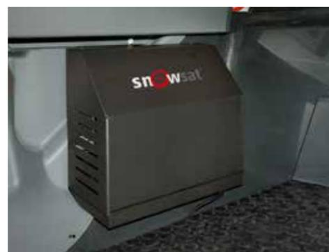
Fahrzeugsystem (GNSS Empfänger und OnBoard Computer)
