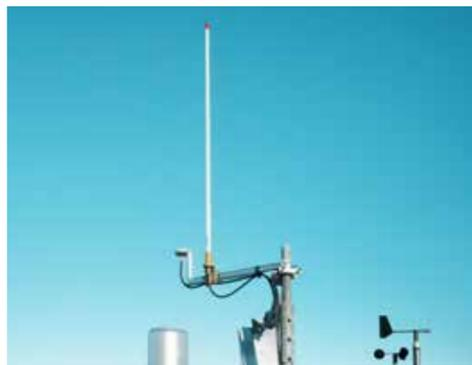
GNSS und UHF Antenne der Basisstation
