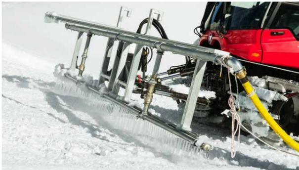
*El propio equipo de la Copa del Mundo desarrolló y construyó esta barra pulverizadora de inyección especial.*
