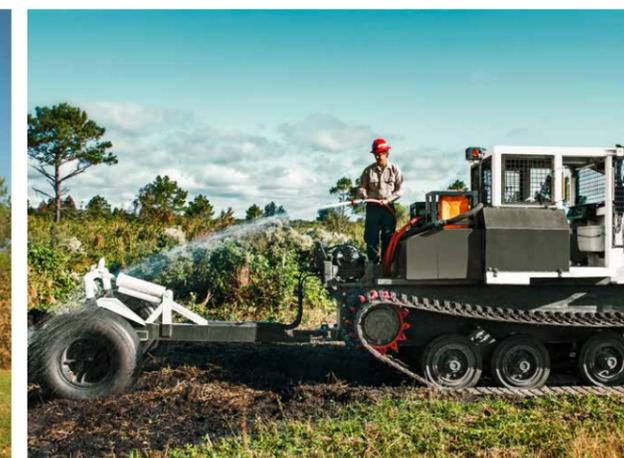
PowerBully 5T FireFighter con cabezal rociador frontal y fijación de cabrestante
