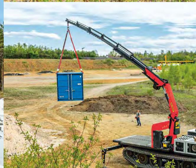
*Con un carico utile di 16,6 tonnellate, il PowerBully 18T costituisce la perfetta base mobile per varie sovrastrutture.*
