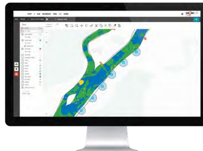
*Tutto sott'occhio: GIS Data Manager mostra la situazione aggiornata dell'innevamento nel comprensorio sciistico. Mediante la funzione drag-and-drop qui è possibile adattare ad esempio i bordi delle piste.*
