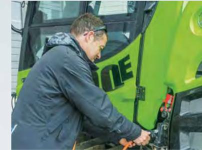
6,5 ore sono attualmente necessarie per una ricarica completa della batteria, che garantisce da 2,5 a 3 ore di lavoro.
