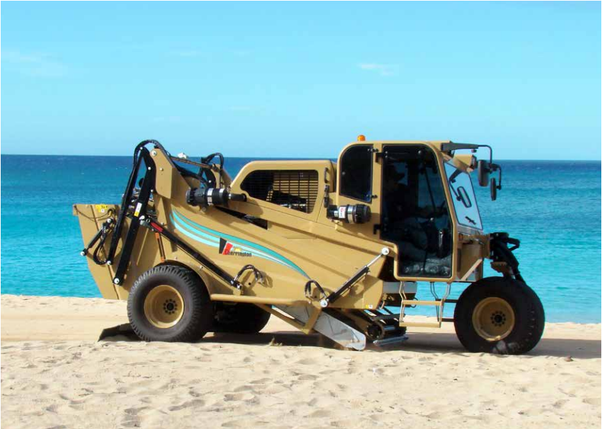
Im Bereich der selbstfahrenden Strandreiniger sind wir nun Spitzenreiter: Zwischen den Cherrington-Modellen 5500 (1,60 m, oben im Bild) und 3000 (0,95 m) steht der BeachTech Marina mit einer Arbeitsbreite von 1,40 m.
