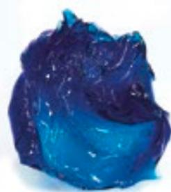
**La consistance ou le grade :** NLGI a établi une échelle pour indiquer la consistance de la graisse qui varie de 000 (graisse fluide) à 6 (graisse dure). Le grade NLGI le plus courant est 2 et il est recommandé pour la plupart des applications en damage.
