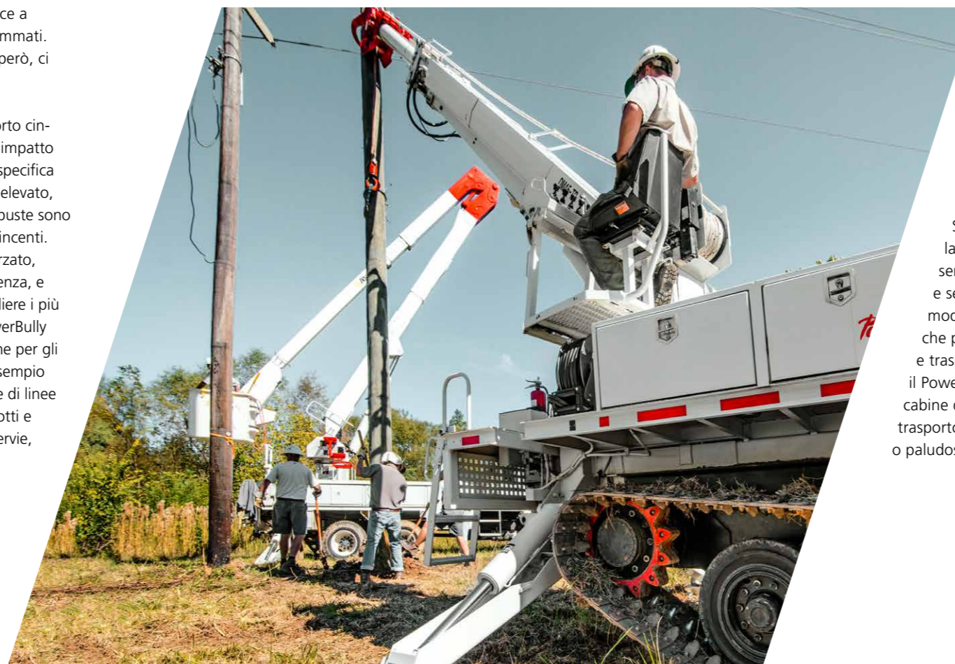
PowerBully adibito alla manutenzione di linee elettriche su terreni estremi.
