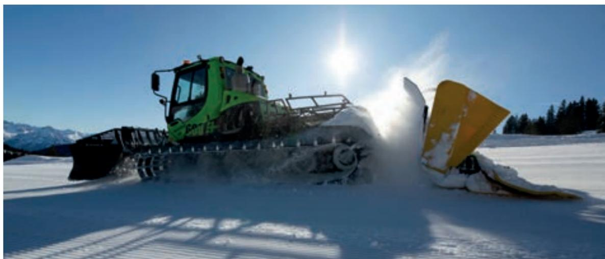
ce qui devrait permettre d'assurer en moyenne 3 heures de travail (soit une bonne heure de plus que la précédente version) et une puissance qui passe de 120 CV à 220 CV avec un couple de 258 Nm. La machine présentée en test est un prototype totalement abouti, dernière étape avant une fabrication en série qui s'annonce à des prix abordables.
