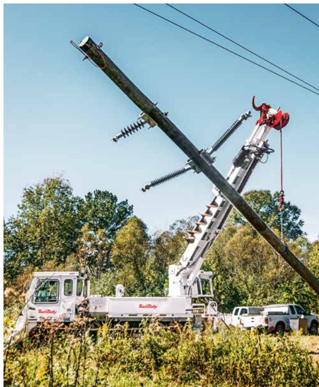
El PowerBully 18T se utiliza, entre otros, por proveedores de energía para la construcción y el mantenimiento de líneas eléctricas.
