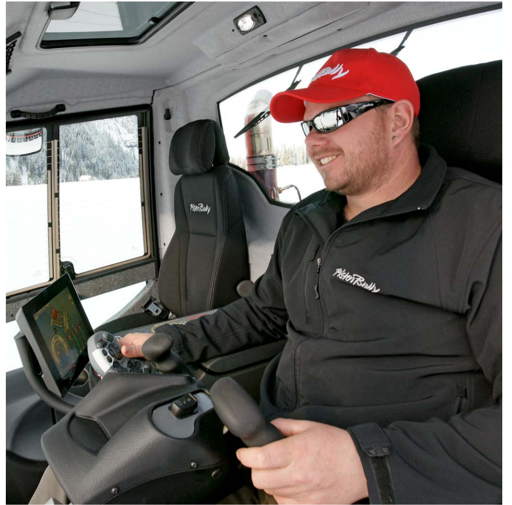
Postazione di lavoro ergonomica: joystick intuitivo, ampio display touch e posto di guida di generose dimensioni rendono più facile il lavoro dell'operatore.
