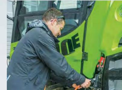
6,5 horas necesita actualmente la batería para cargarse por completo – y poder trabajar durante 2,5 o 3 horas.
