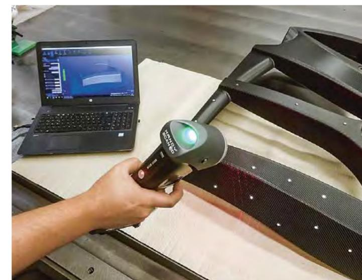
*Medición de geometrías 3D con tecnología de escáner de última generación.*
