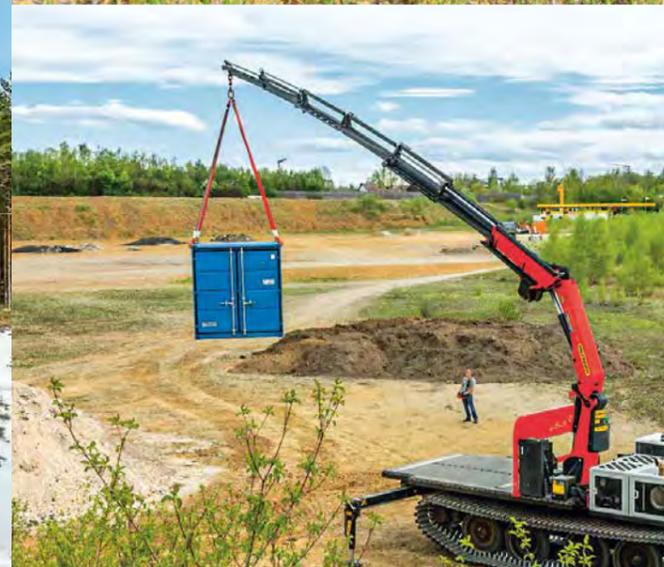
Con una carga útil de 16,6 toneladas, el PowerBully 18T es la base móvil perfecta para múltiples superestructuras.
