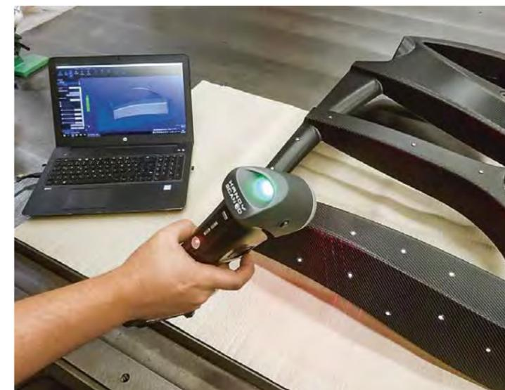
*Mesure de géométrie 3D avec une technologie de balayage des plus modernes.*
