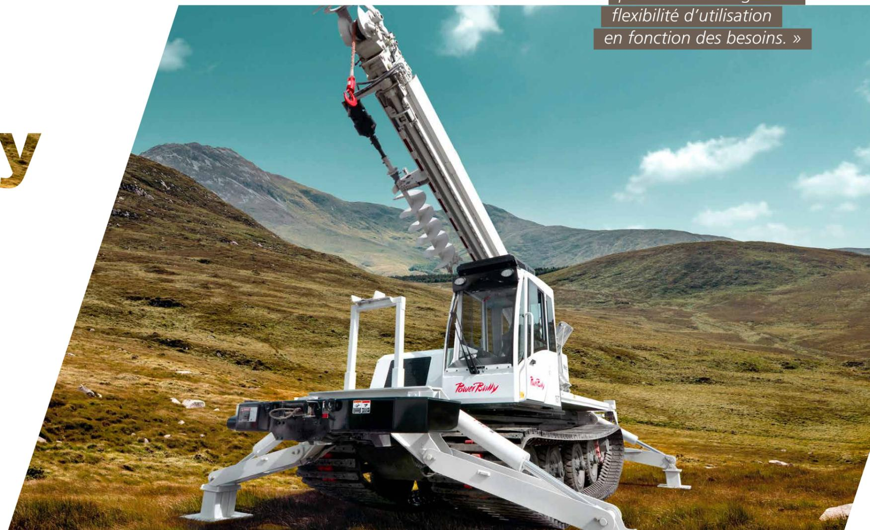
Sur son châssis QuikMount, le PowerBully 15T peut supporter des charges utiles jusqu'à 16 tonnes dédiées à de multiples applications. Grâce à un système de fixation rapide, des superstructures telles que des grues de forage, des grues articulées ou des nacelles élévatrices peuvent être montées de manière simple et rapide sur la plate-forme.
