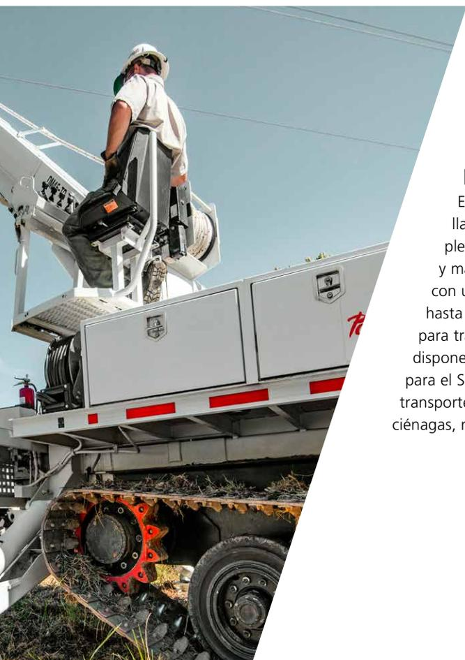
*PowerBully realizando el mantenimiento de tendido eléctrico en terreno no asfaltado.*
