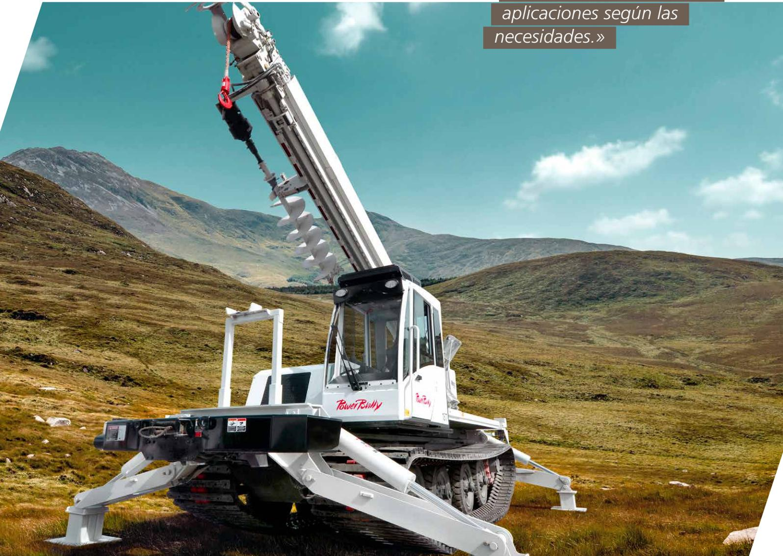
Partiendo del chasis QuikMount, el PowerBully 15T soporta hasta 16 toneladas de carga útil para diferentes ámbitos de aplicación. Con ayuda de este sistema de cambio rápido, se pueden montar en el bastidor de forma rápida y sencilla distintos tipos de estructuras, como grúas de perforación y de brazo acodado, o plataformas de trabajo elevadoras.
