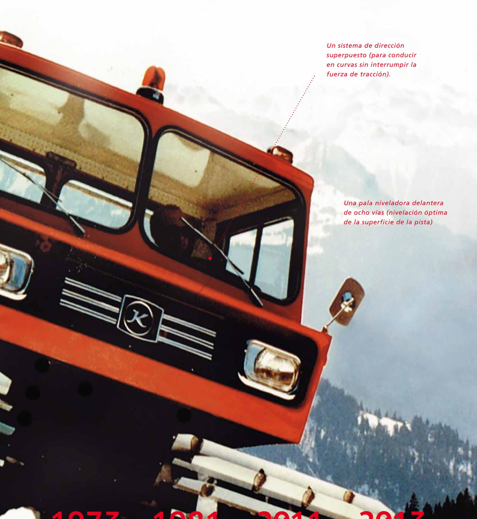
*Un sistema de dirección superpuesto (para conducir en curvas sin interrumpir la fuerza de tracción).*
