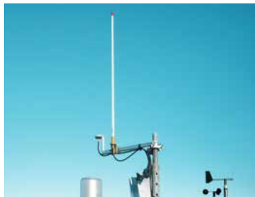
Antenna GNSS e UHF della stazione base
