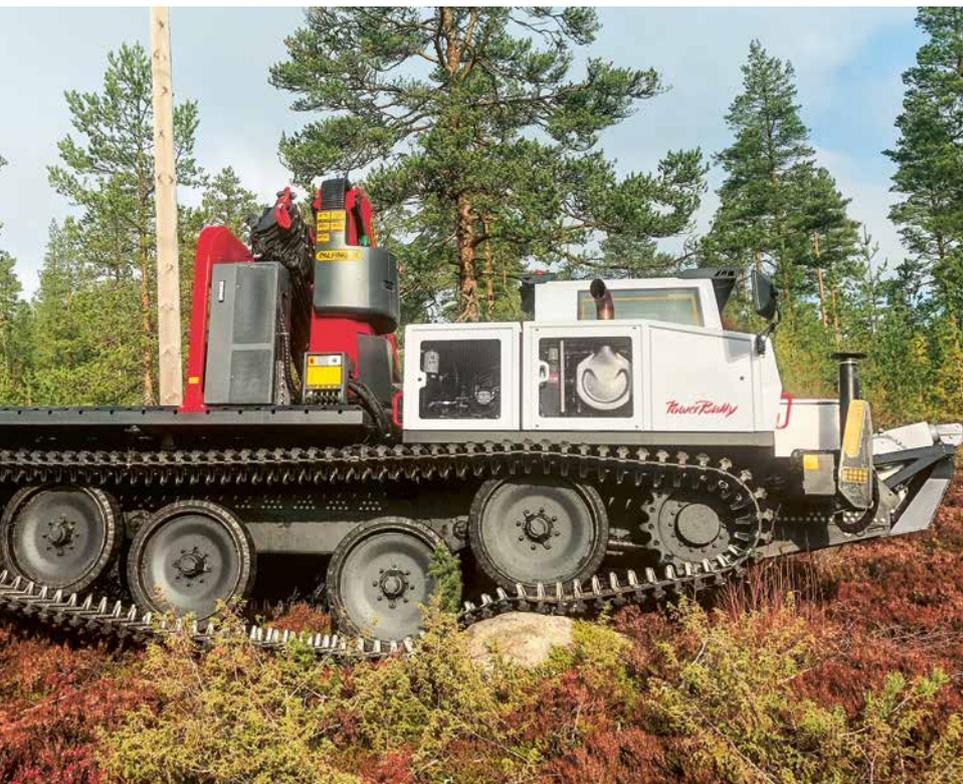
Le PowerBully 18T a une charge utile de plus de 16 tonnes. Équipé d'une PK 23002 SH à flèche articulée et d'une nacelle, il est utilisé par une entreprise scandinave. Grâce aux roues de grandes dimensions, le PowerBully 18T s'adapte parfaitement au sol et est donc idéal pour une utilisation tout-terrain.
