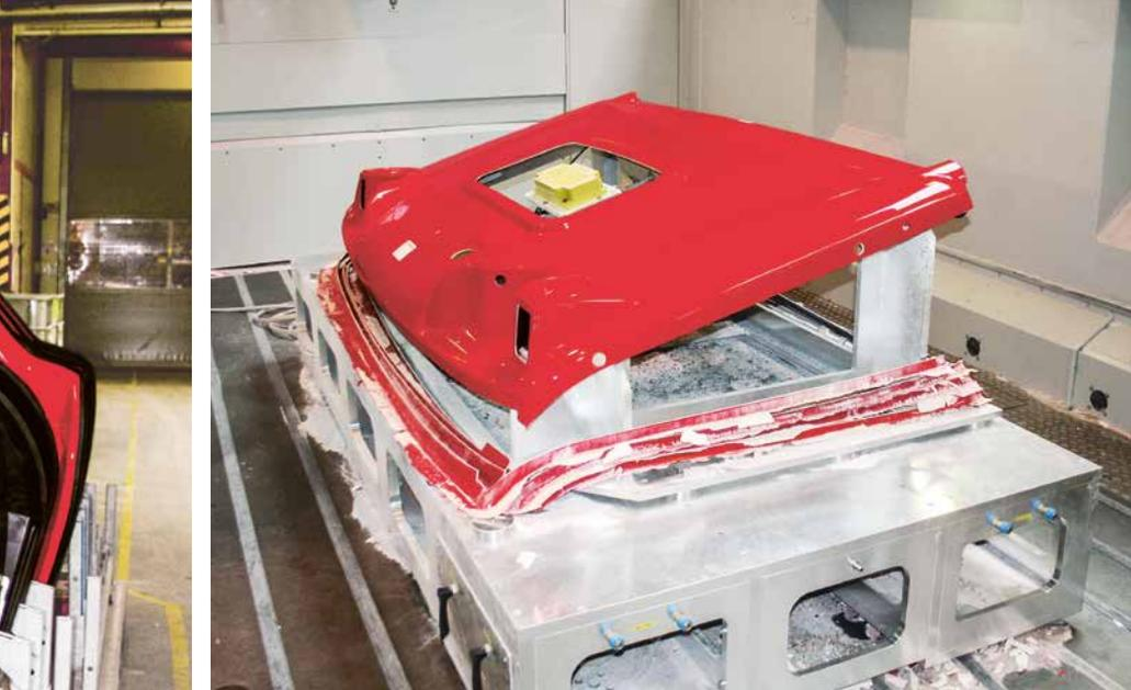
*Toit du PistenBully 600 après traitement dans le nouveau dispositif de fraisage.*
